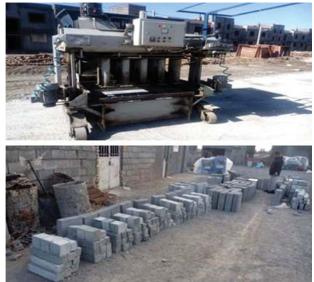
شکل ۱. دستگاه جدول پرسی خشک به همراه تعدادی از جدول‌های بتنی.
