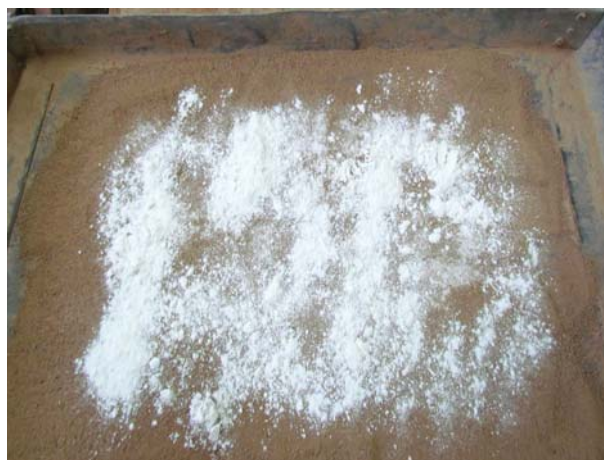
شکل ۵. ترکیب نانوسیلیس با خاک واگرا.
