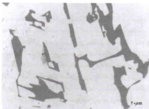
ب) ضخامت ۳ میلی متر بزرگنمایی ۵۰۰x شکل ۵. تأثیر سرد کردن (تغییر ضخامت نمونه های پله ای) بر ریزساختار نمونه های پله ای بهسازی نشده.
