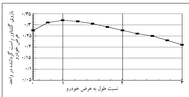
شکل ۱۱. رابطه‌ی بین بازوی گشتاور راست‌گرداننده نیروی وزن با نسبت طول به عرض خودرو طراحی شده.
