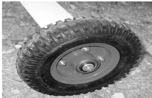
شکل ۱۶. چرخ لاستیکی عقب با تیوب بادی.
