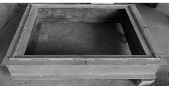
شکل ۳. قاب فولادی استفاده شده به‌عنوان تکیه‌گاه دال.
