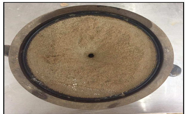
شکل ۲. نمونه خاک قرار گرفته در قالب دستگاه فرسایش حفره‌یی.
