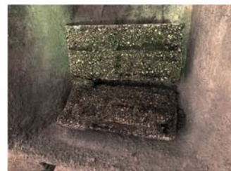
الف) نمونه فاقد الیاف پس از آزمایش دو نیم شدگی؛
