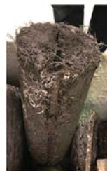
ب) نمونه دارای الیاف پس از آزمایش دو نیم شدگی؛
