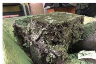
ج) نمونه دارای الیاف پس از آزمایش فشاری.
