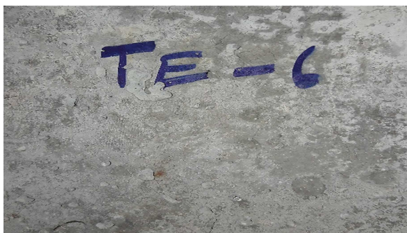
شکل ۱۳. سطح نمونه‌های طرح TE بعد از حرارت‌دهی در ۴۰۰ درجه سانتی‌گراد.
