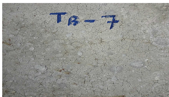
شکل ۱۲. سطح نمونه‌های طرح TB بعد از حرارت‌دهی در ۸۰۰ درجه سانتی‌گراد.
