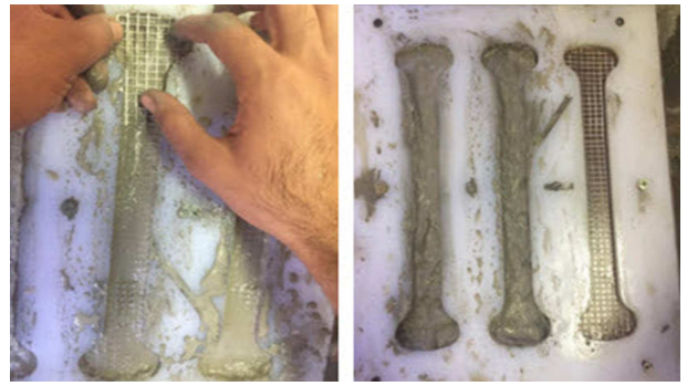
شکل ۳. نحوه ساخت نمونه‌های کششی با بافته‌های شیشه.
