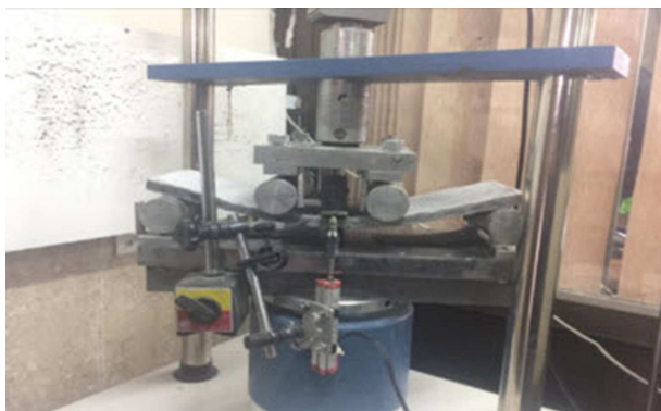
شکل ۷. پانل ECC مسلح شده به بافته‌های شیشه تحت آزمایش خمش.
