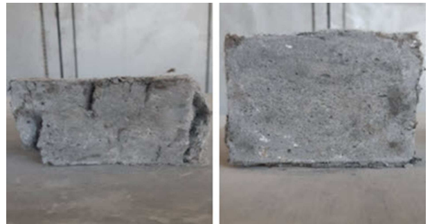
شکل ۴. توانایی بالای ECC در فشرده شدن بدون وقوع جداشدگی کامل.
