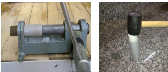
شکل ۴: (ب) دستگاه جک بیرون آورنده نمونه تک‌محوری از قالب. (ا) قالب نمونه، چکش و میله تفلونی جهت
