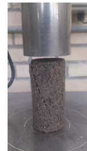
شکل ۶: نمونه شکست برشی نمونه در دستگاه تک‌محوری.
