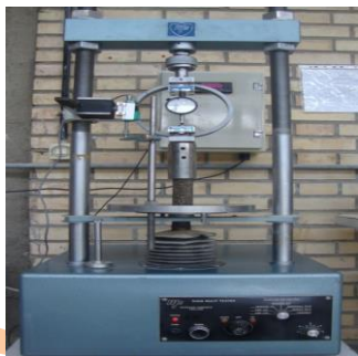
شکل ۳: دستگاه انجام آزمایش تک‌محوری محصور نشده UCS.
