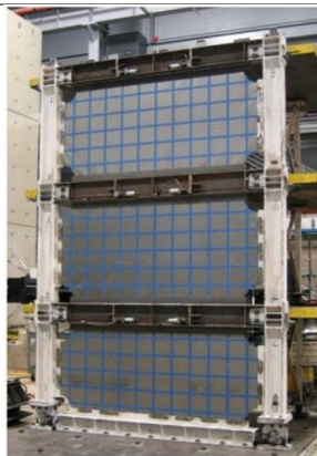
شکل ۱: مدل آزمایشگاهی دیوار برشی فولادی مرکزگرا با مقیاس ۱ به ۳ [۶]
