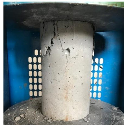
شکل ۲: نمونه بتنی درون جک جهت انجام مقاومت فشاری
