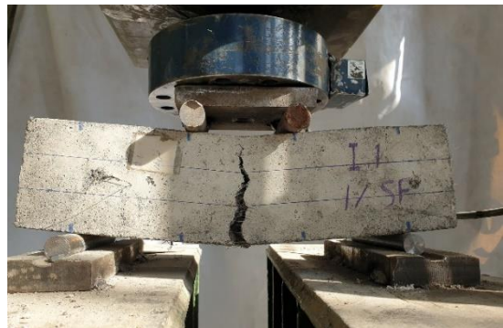
شکل ۴: نمونه بتنی تحت خمش
