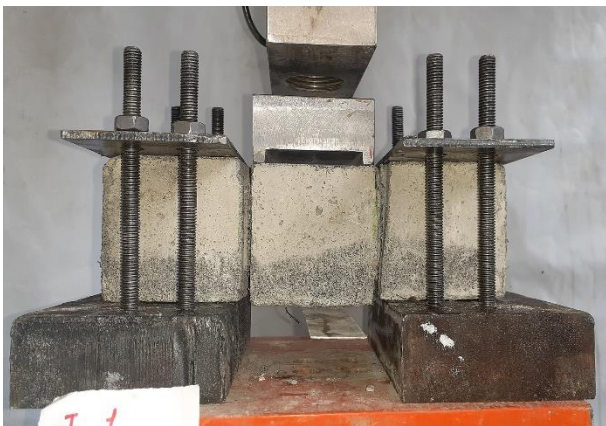
شکل ۶: نمونه بتنی تحت اعمال نیروی برشی
