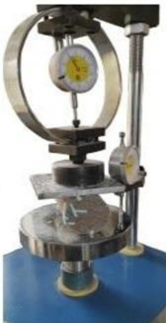
شکل ۲: نحوه قرارگیری نمونه‌ها و انجام آزمایش کشش غیر مستقیم برزیلی
