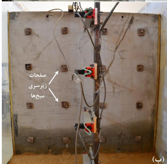
شکل ۴: تصویری از: الف) روند آماده‌سازی المان رویه کوچک مقیاس؛ ب) المان رویه داخل جعبه میز لرزه
