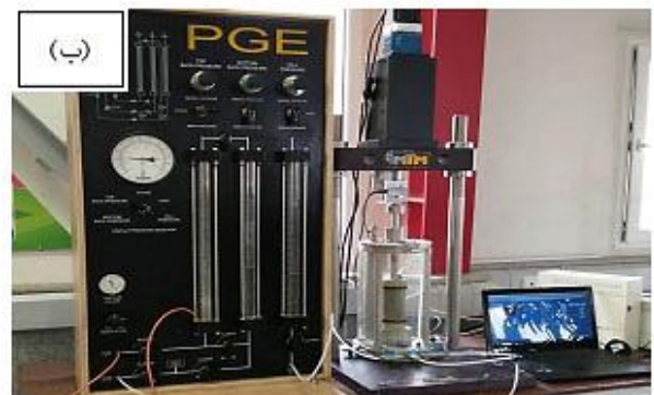
شکل ۲. شمای کلی (الف) دستگاه سه محوری استاتیکی (ب) دستگاه سه محوری دینامیکی.
