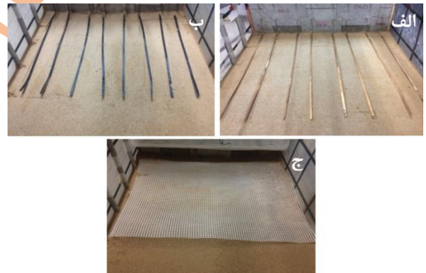
شکل ۲: المان‌های مورد استفاده در بدنه مدل‌ها: الف) تسمه فلزی، ب) تسمه پلیمری و ج) ژئوگرید
