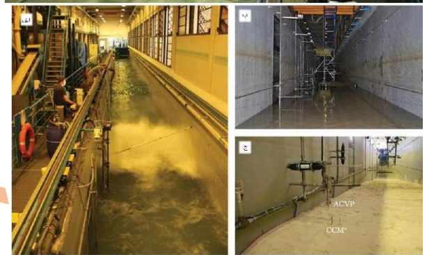
الف) شکست شیرجه ای امواج در فلوم، ب) قاب متحرک حامل ابزارهای اندازه گیری، ج) نمای بستر ماسه‌ای به همراه ابزارهای ACCV و CCM+
