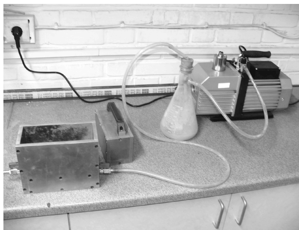
شکل ۲. قالب استفاده‌شده برای ساخت نمونه‌ها.
