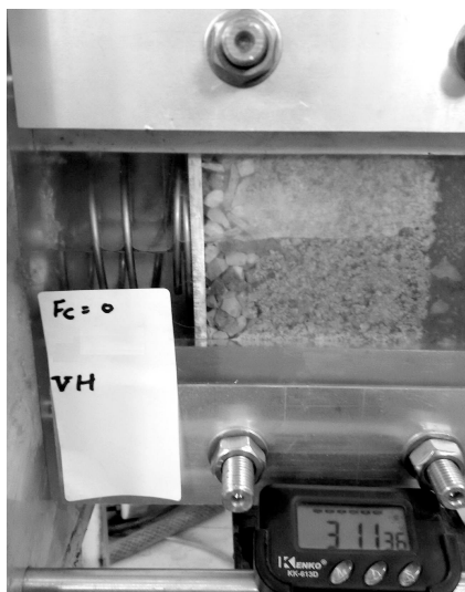
شکل ۱۱. حالت ترک خوردگی قائم و جریان افقی.
