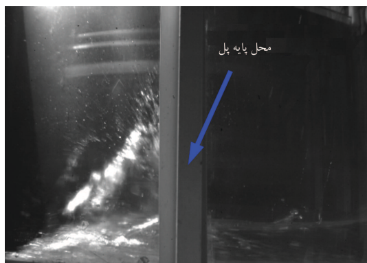
شکل ۲۹. تصویر به‌دست‌آمده از دوربین سرعت بالا، ۳۳/۰ ثانیه بعد از بازشدن دریچه.
