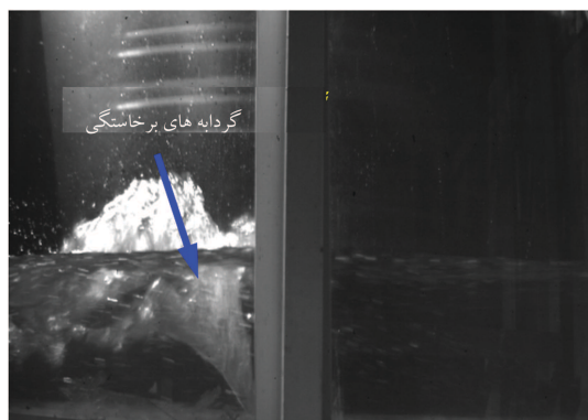
شکل ۳۰. تصویر به‌دست‌آمده از دوربین سرعت بالا، ۶۵/۱ ثانیه بعد از بازشدن دریچه.
