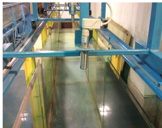
شکل ۵. نمای کلی از دستگاه آلتراسونیک و نحوه نصب آن.
