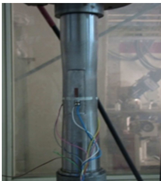
شکل ۵. شکل کلی و کرنش‌سنج‌های نصب شده بر روی نمونه‌ی دارای خوردگی.
