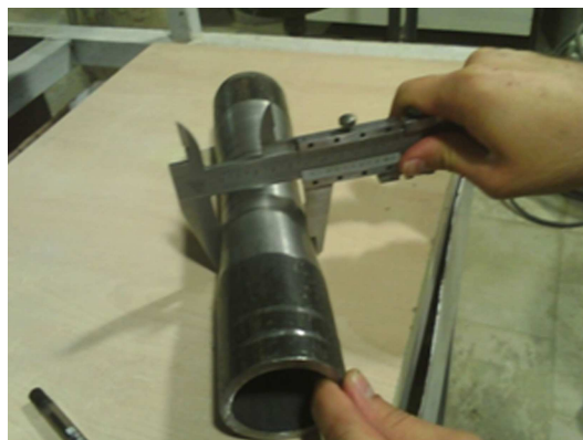
شکل ۳. اندازه‌گیری و کنترل ابعاد لوله‌ها با کولیس.
