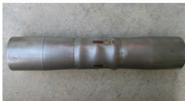
شکل ۷. نمونه‌ی سالم مورد آزمایش قبل و بعد از اعمال بار محوری (چین‌خوردگی‌های ایجاد شده).
