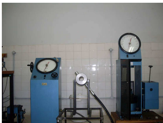
شکل ۹. آزمایش سه‌محوره‌ی نانو بتن خودمترکم مقاومت بالا.
