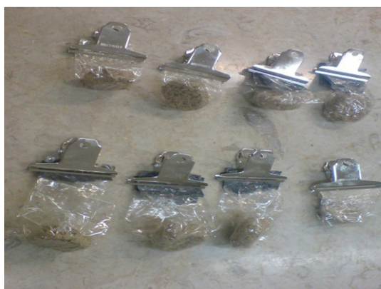
شکل ۶. نحوه‌ی قرارگیری نمونه‌ها در غشاء نیمه تراوا و محلول PEG.
