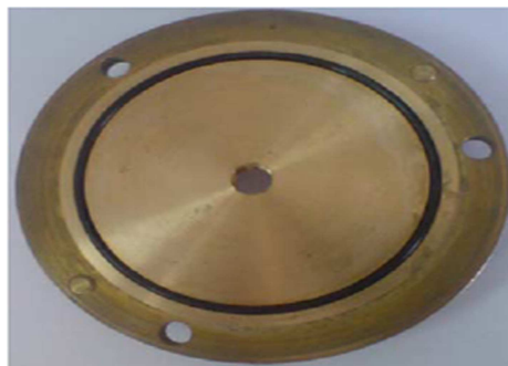
شکل ۲. رینگ اصلاح‌شده‌ی ادنومتر دیافراگمی اسموتیک.
