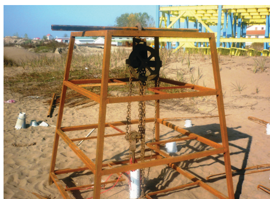
شکل ۸. تجهیزات خارج کردن غلاف از داخل خاک.
