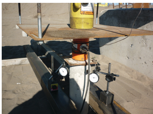
شکل ۱۱. تجهیزات اندازه‌گیری نیرو و جابجایی شمع.
