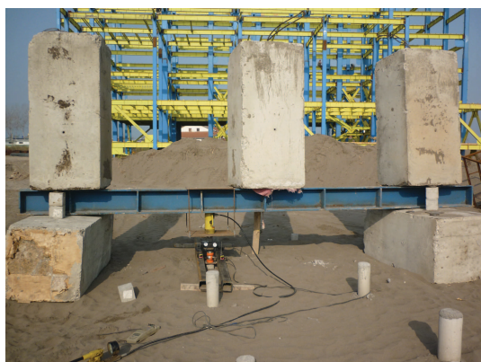
شکل ۱۰. نحوه قرارگیری وزنه‌ها روی تیوروق آزمایش بارگذاری.
