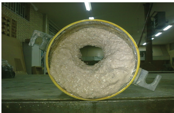
شکل ۱۰. تصویر قطر نهایی سوراخ پیش شکل‌گرفته‌ی ماسه‌ی رس‌دار کاتولینیتی بعد از انجام آزمایش فرسایش حفره - هد ۵۰ میلی‌متر.
