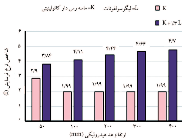
شکل ۹. نمودار مقایسه‌ی شاخص نرخ فرسایش ماسه‌ی رس‌دار کاتولینیتی تثبیت نشده و تثبیت شده با ۳٪ لیگنوسولفونات در هدهای مختلف.
