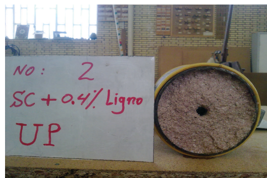
شکل ۱۱. تصویر قطر نهایی سوراخ پیش شکل گرفته ی ماسه ی رس دار کائولینیتی تثبیت شده با ۴٪ لیگنوسولفونات بعد از انجام آزمایش فرسایش حفره - هد ۵۰ میلی متر.
