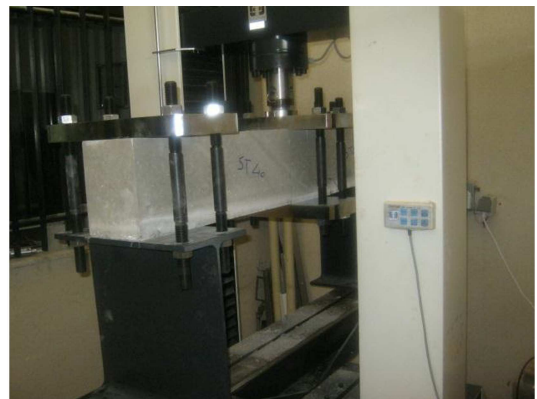
شکل ۲. نمای دستگاه بارگذاری یونیورسال.
