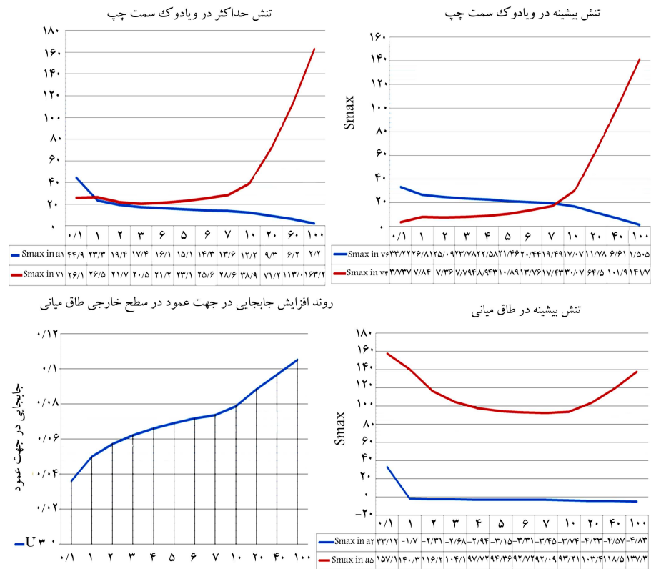
شکل ۱۳. مقادیر تنش و جابه‌جایی در داخلی و خارجی ترین نقاط در mهای متفاوت.
