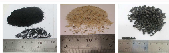
شکل ۲. گرانول لاستیک، ماسه و پودر لاستیک.
