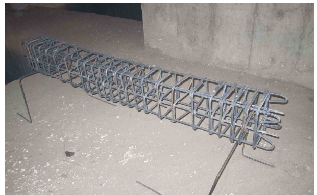
شکل ۴. نمونه‌ی میلگردگذاری طولی و عرضی مدل آزمایشگاهی.
