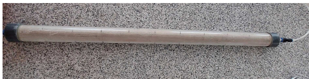
شکل ۴. قالب تزریق استوانه‌ای مدرج با قطر داخلی ۳/۸ و طول ۱۰۰ سانتی متر جهت آزمایش تزریق پذیری.
