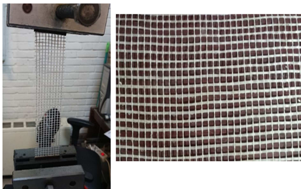
شکل ۳. الف) مش الیاف شیشه و ب) نمونه آماده شده به منظور انجام آزمایش کشش.
