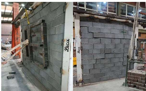
شکل ۱۲. الگوی ترک و خرابی در نمونه شماره ۱ در تغییر مکان نسبی ۰/۱۵ درصد.
