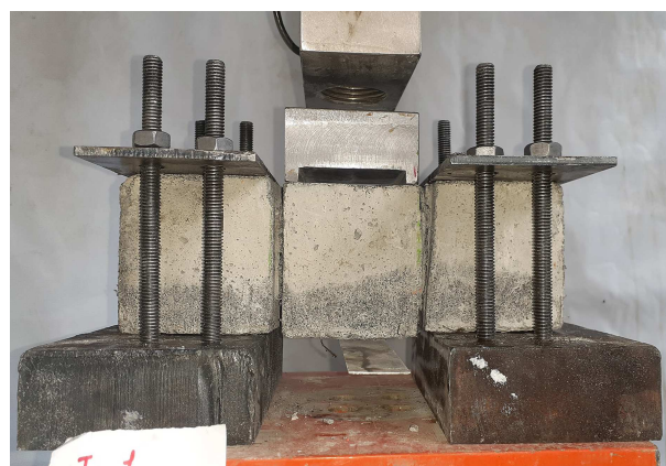
شکل ۶. نمونه‌ی بتنی تحت اعمال نیروی برشی.
