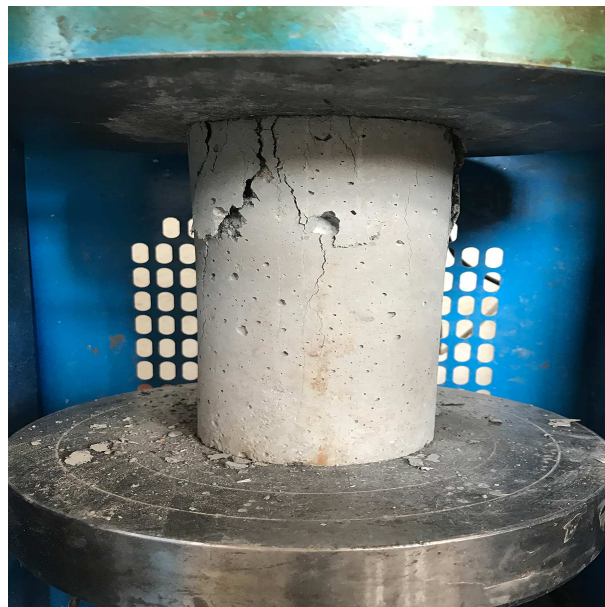
شکل ۲. نمونه‌ی بتنی درون جک جهت انجام آزمایش مقاومت فشاری.
