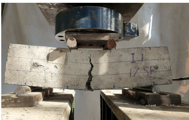
شکل ۴. نمونه‌ی بتنی تحت خمش.
