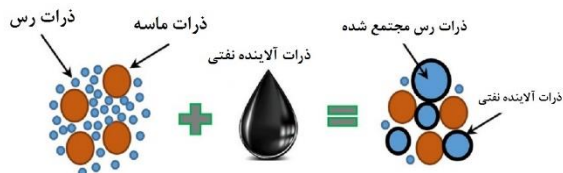
شکل ۱۶: شماتیک تاثیر آلاینده نفتی بر روی ریزساختار
