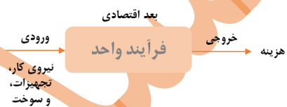
شکل ۷: فرآیندهای واحد در روش پیشنهادی برای ارزیابی پایداری چرخه عمر رویه‌های بتنی و مرزهای سیستم در روش پیشنهادی برای ارزیابی پایداری چرخه عمر رویه‌های بتنی
