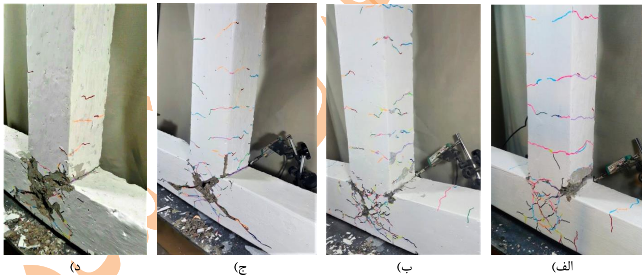
شکل ۶. مودهای خرابی نهایی نمونه‌های اتصال: الف) SP۱، ب) SP۲، ج) SP۳، د) SP۴.
