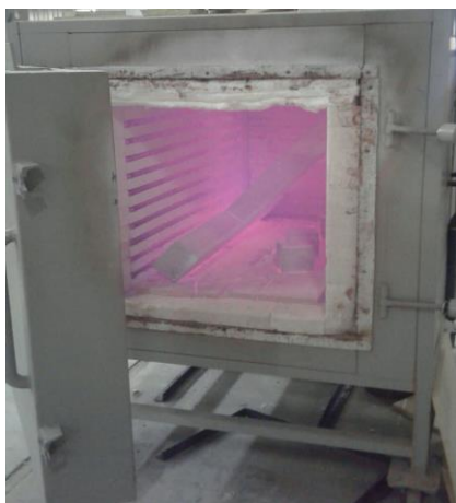
شکل ۳. محفظه کوره الکتریکی با حرارت ۶۰۰ درجه سانتی‌گراد.
