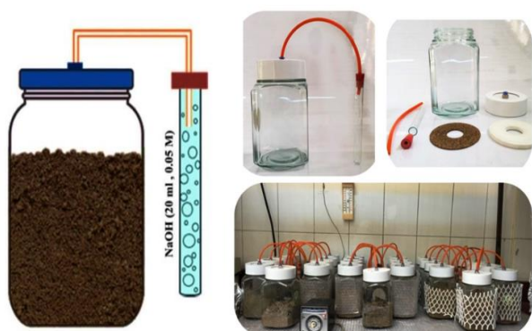
شکل ۱. تصویر و شماتیک پایلوت استفاده شده.
