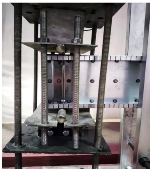
شکل ۸: اتصال مفصلی محل اعمال نیروی جک
