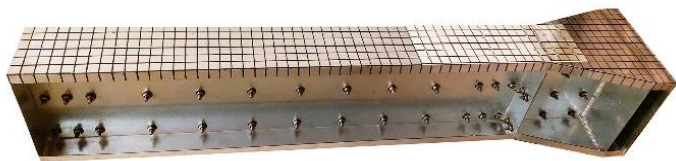
شکل ۲: نمونه آزمایشگاهی تیر و اتصال CCDP
