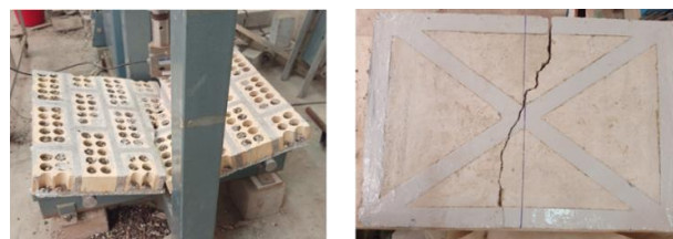
شکل ۸. تصویر شکست دیوار W3 (نمای جلو و پشت دیوار).
