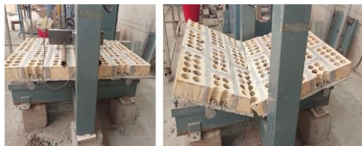
شکل ۵. نمایی از اجرای دستگاه خمشی چهار نقطه‌ای.
