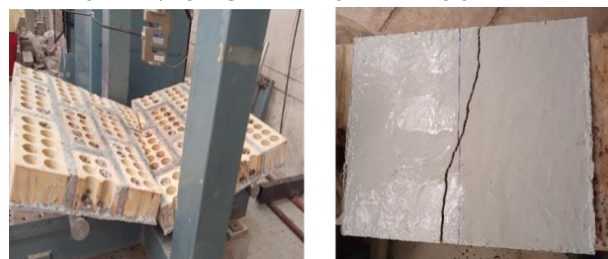
شکل ۹. تصویر شکست دیوار W4.
