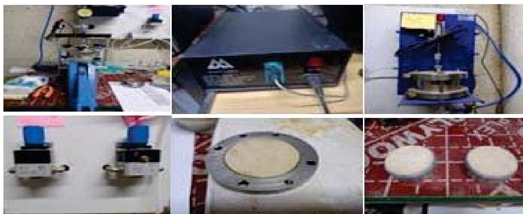
شکل ۲. دستگاه تحکیم غیراشباع مورد استفاده در پژوهش حاضر.
