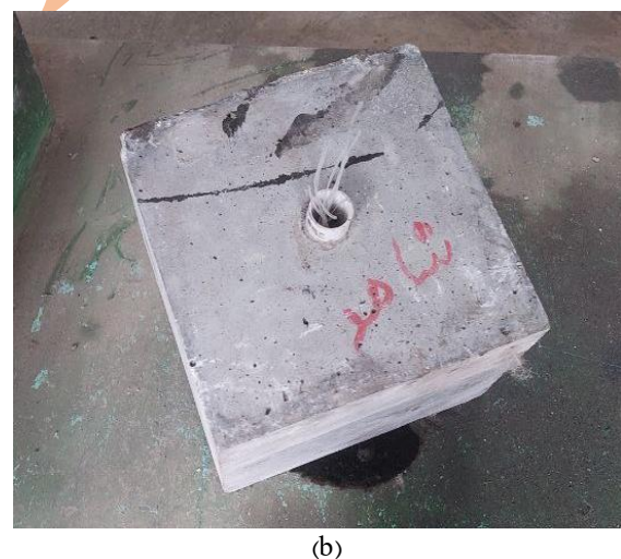
شکل ۷: (a) منحنی نیرو - جابه‌جایی و (b) مکانیزم خرابی برای بیرون کشیدگی طناب بافته شده از پلی‌اتیلن ترفتالات از بتن نمونه FRCC-Pullout-۰,۰
