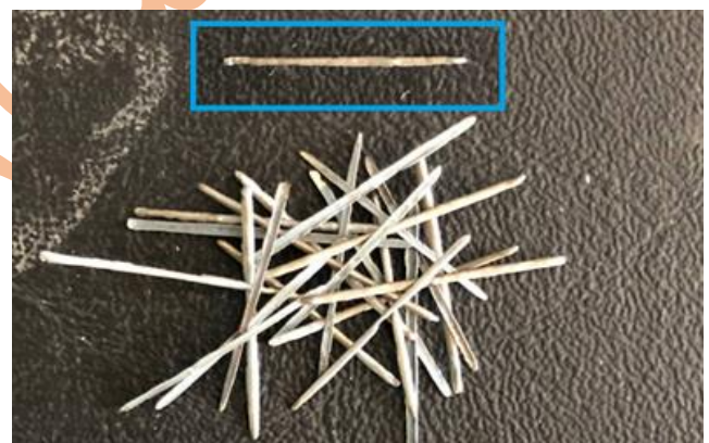
شکل ۱: میکرو الیاف فولادی مورد استفاده
