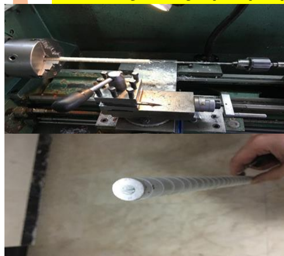
شکل ۱: میلگردهای هیبریدی ساخته‌شده با هسته فوم پلی‌یورتان
