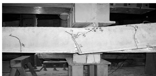
پ) مد شکست در نمونه ۳
