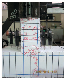
الف) ترک های خمشی اتصال در انحراف ۳٪
