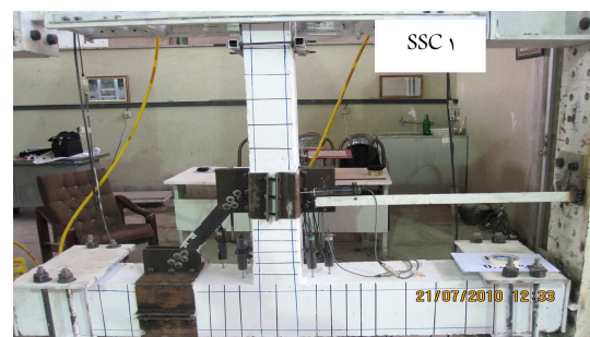
شکل ۴. نحوه‌ی مقاومت‌سازی نمونه‌ی واقعی اتصال SC1.
