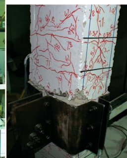
د) وضعیت نهایی اتصال مقاوم سازی شده در انحراف ۸٪.
