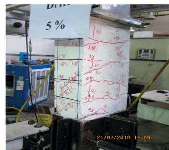
ج) بروز ترک های برشی در ارتفاع تیر در انحراف ۵٪
