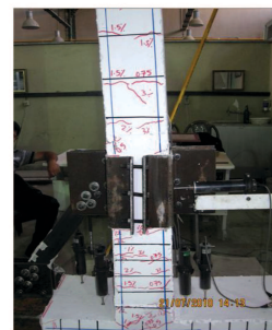
الف) ترک های خمشی اتصال در انحراف ۳٪
