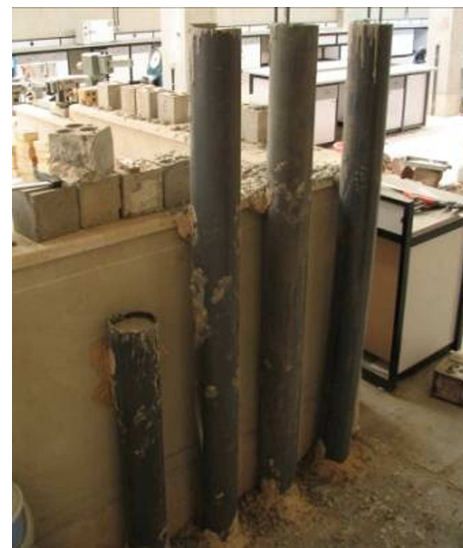
شکل ۱. نمونه‌ی ستون‌های تهیه‌شده از بتن خودمتراکم.
