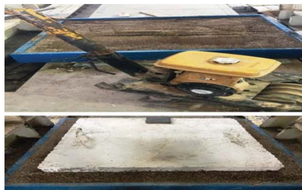
شکل ۳. بستر خاکی متراکم شده به وسیله کمیکتور.
