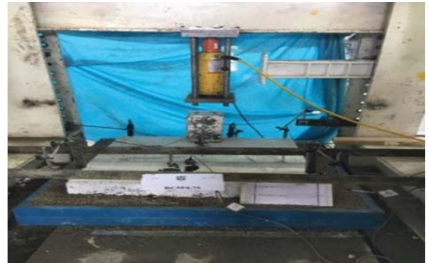
شکل ۶. سیستم قرارگیری و نحوه آزمایش دال بتنی روی بستر خاکی.
