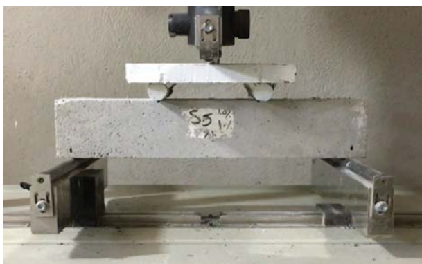
شکل ۴. آزمایش مقاومت خمشی چهار نقطه‌یی.
