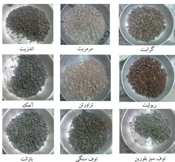
شکل ۱. شکل سطحی سنگ‌دانه‌های شکسته شده در آزمایشگاه.
