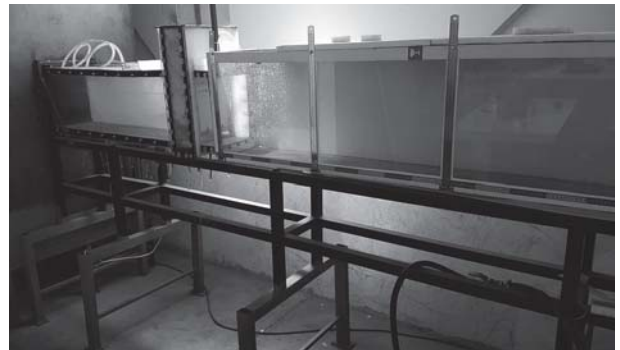
شکل ۲. نمای قسمت‌های مخزن بالادست، مجرای تحت فشار، دریچه‌ی کنترل و مجرای جریان آزاد.
