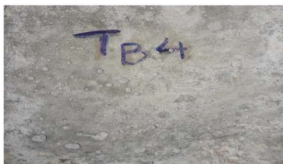
شکل ۱۱. سطح نمونه‌های طرح TB بعد از حرارت‌دهی در ۴۰۰ درجه سانتی‌گراد.
