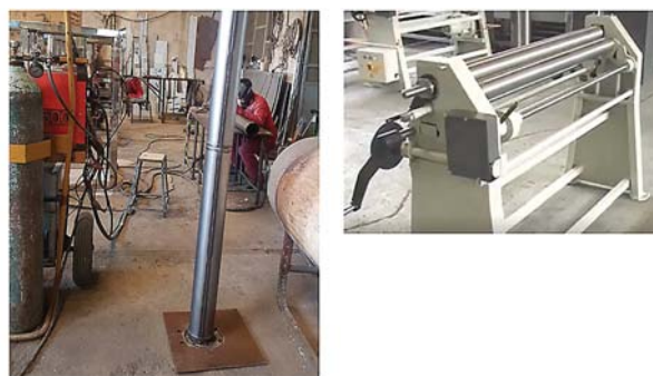
شکل ۵. دستگاه نورد و نمایی از نمونه‌ی ساخته شده با جوش آرگون.
