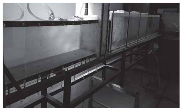
شکل ۳. نمای قسمت‌های مجرای تحت فشار، دریچه‌ی کنترل، مجرای جریان آزاد و مخزن پایین دست.
