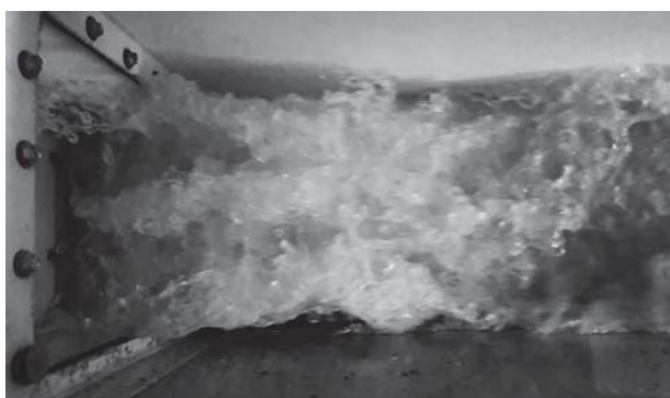
شکل ۷. نمای فوقانی شکل ۶ از وضعیت تلاطم جریان عبوری از زیر دریچه‌ی کنترل.
