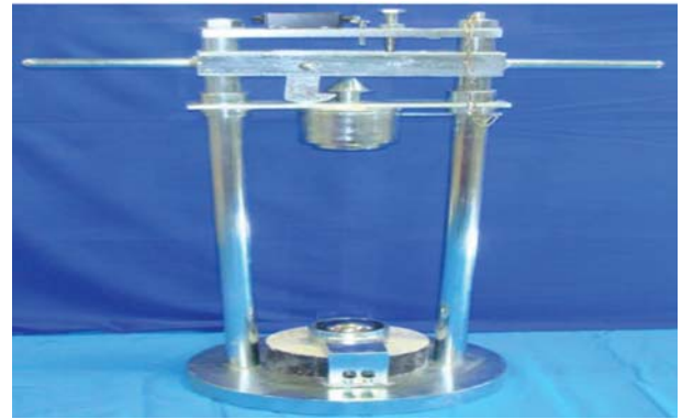
شکل ۵. دستگاه آزمایش ضربه (سقوط افتان).
