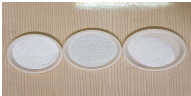
شکل ۲. نانوسیلیس‌های استفاده شده در آزمایش (به ترتیب از راست به چپ: نانوسیلیس ۱۰، نانوسیلیس ۱۵ و نانوسیلیس ۳۰).
