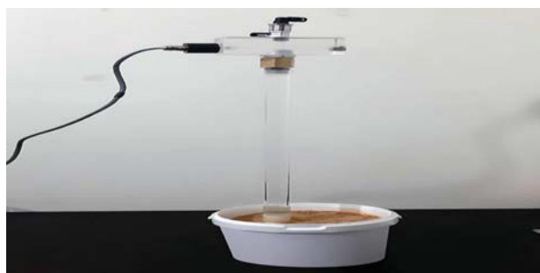
شکل ۱۰. اندازه‌گیری مکش بافتی نمونه‌ی خاک با نسبت تخلخل اولیه‌ی ۰/۹ در مسیر خشک‌شدگی با استفاده از تنسیومتر صحرایی.
