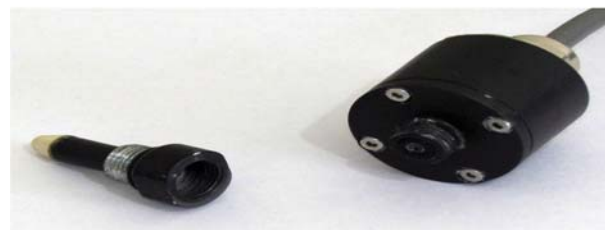
شکل ۳. اجزاء مختلف تنسیومتر مینیاتوری جدید.
