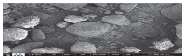
شکل ۹. تصاویر الکترونی (SEM) سنگدانه‌های آسفالتی.
