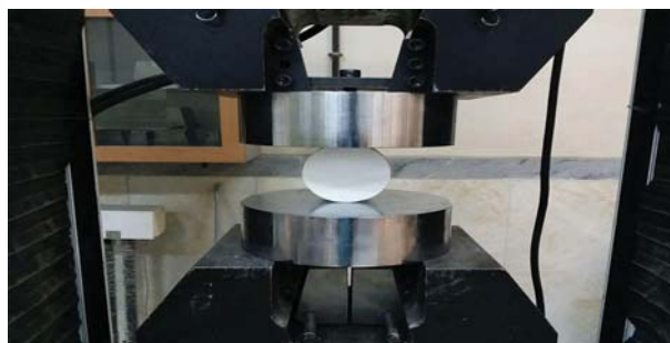
شکل ۴. دستگاه آزمایش و نمونه‌ی برزلی قرار داده شده بین دو فک آن.
