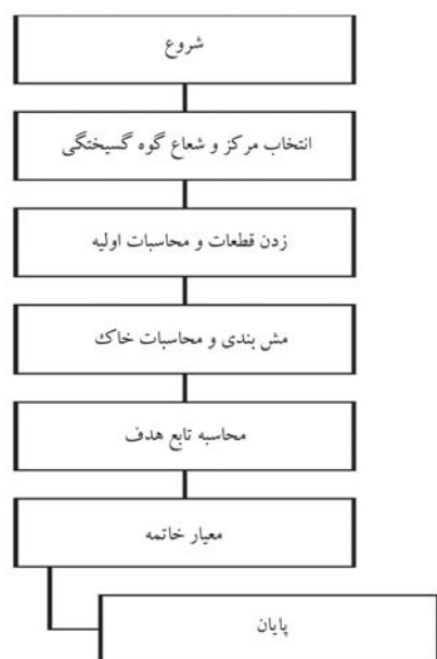
شکل ۶. تعیین گوهی گسیختگی با روش بهینه‌سازی.
