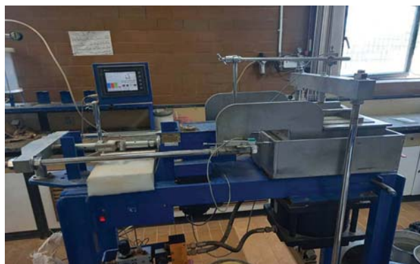
شکل ۶. دستگاه برش مستقیم بزرگ مقیاس موجود در آزمایشگاه.
