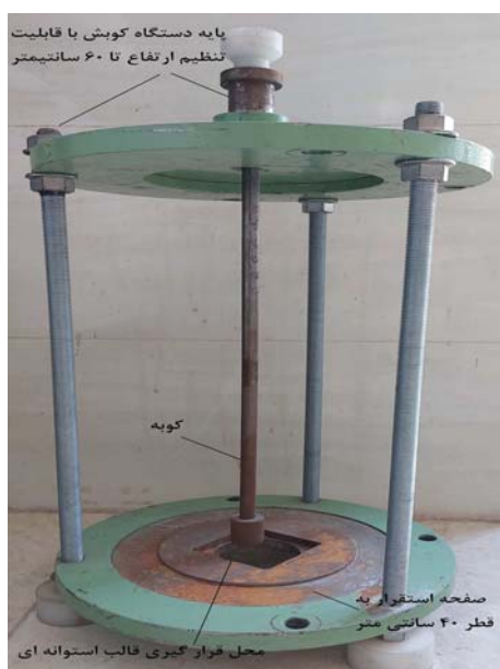
شکل ۶. دستگاه کوبش با ارتفاع قابل تنظیم در روش تراکم کاهش یافته.
