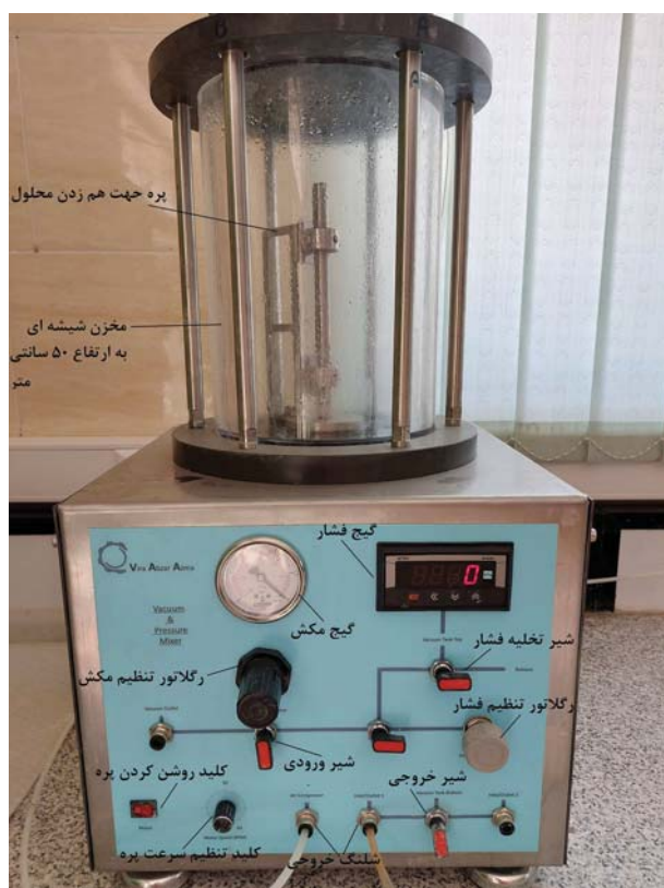
شکل ۳. دستگاه تزریق با اعمال فشار و مکش قابل تنظیم.
