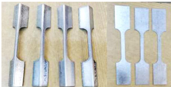
شکل ۴: نمونه‌های کوپن تیر و اتصال.
