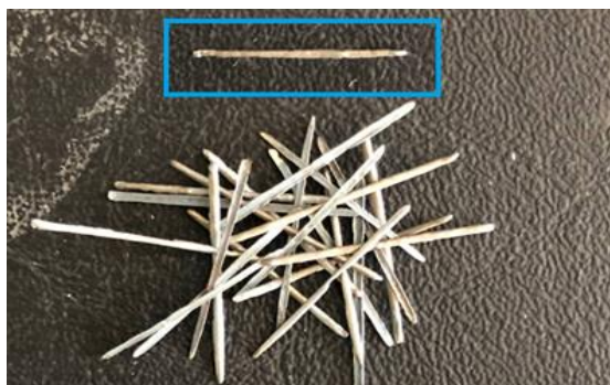
شکل ۱. میکروالیاف فولادی استفاده‌شده.
