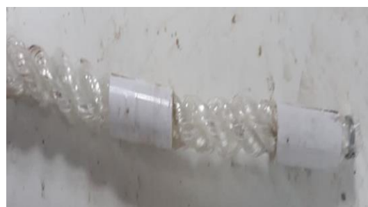
شکل ۲. نمونه‌ای از طناب بافته‌شده از پلی‌اتیلن ترفتالات.
