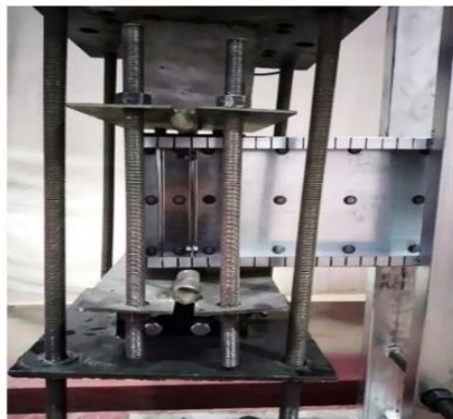
شکل ۸. اتصال مفصلی محل اعمال نیروی جک.
